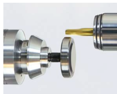
Měření poloměru nástroje speciálním měřicím hrotem
