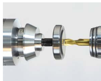
Měření délky nástroje speciálním měřicím hrotem
